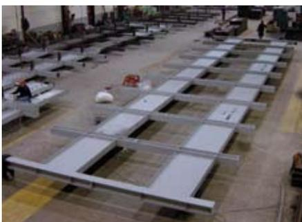
*Fabrication hors chantier des panneaux structuraux de façade*
