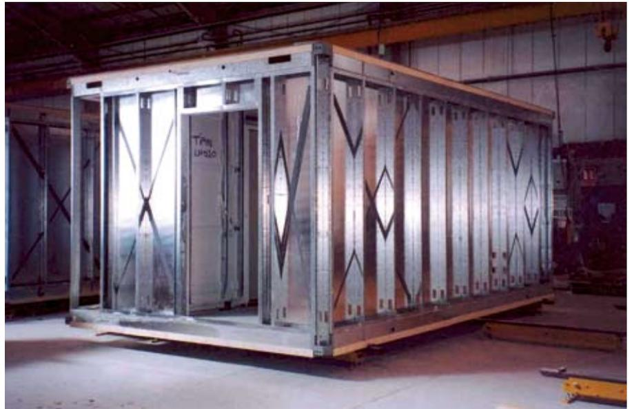
Figure 6.2 Module avec murs porteurs
