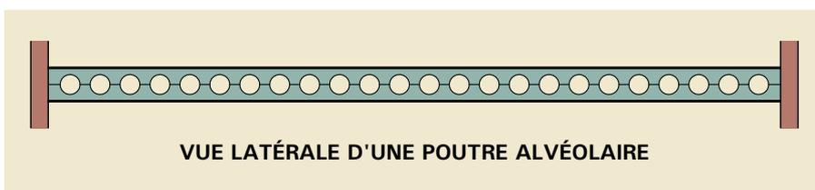
Figure 3.9 Poutres alvéolaires (poutres secondaires de grande portée) et dalles mixtes - exemple de disposition de structure de plancher en acier pour un bâtiment à trame rectangulaire de 8 étages
