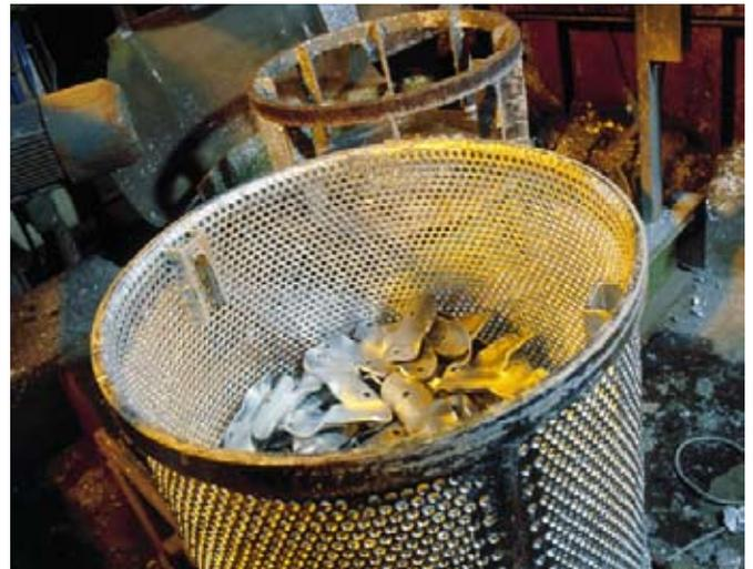
Après avoir été prêtaitées, les pièces sont galvanisées dans des paniers. Ces paniers sont placés dans une centrifuge en sortie du bain de zinc. Cette centrifuge essore le zinc qui n'a pas réagi. La couche de zinc obtenue est donc un peu plus fine que dans le cas du procédé discontinu de galvanisation à chaud.
