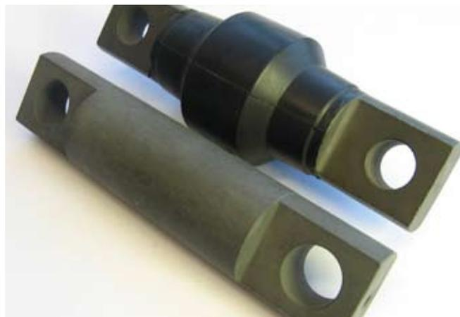
Ce procédé permet la formation d'un revêtement de type alliage fer-zinc régulier, résistant à la chaleur, aux chocs, aux rayures et l'abrasion, avec une résistance à la corrosion durable. L'épaisseur de couche obtenue est de 15 – 25  $\mu m$ .
